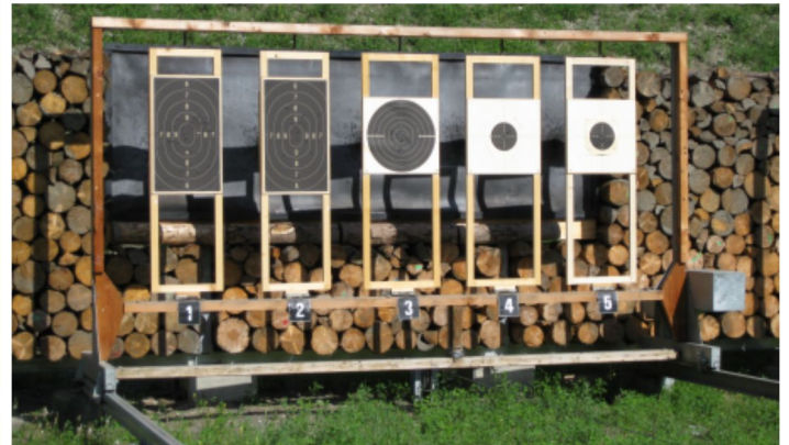
Abb. 23: 25m Schiessanlage Rossboden, Chur: Scheibenwagen mit 5 Drehscheiben. Foto magma AG, 14.8.2009.
